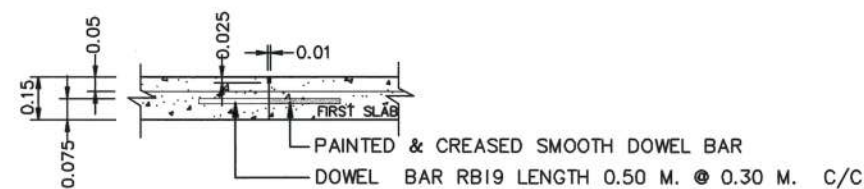
ขยาย CONSTRUCTION JOINT (รอยต่อตีขาด)
